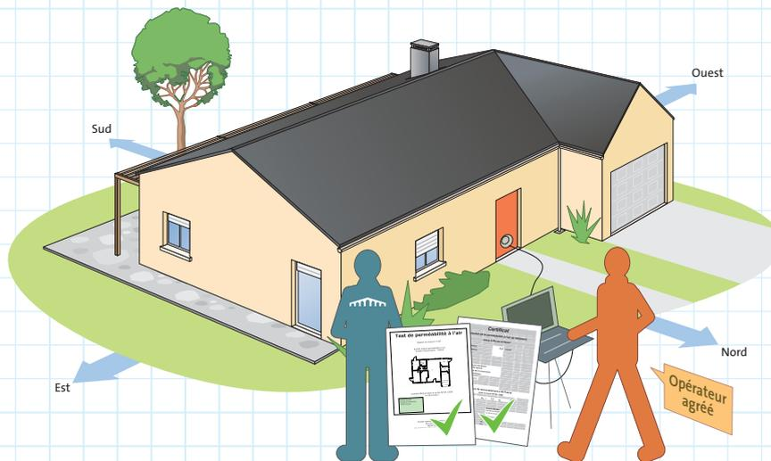
Un opérateur autorisé par le Ministère en charge de la construction a été mandaté pour réaliser la mesure de perméabilité à l'air. Le résultat de la mesure est une perméabilité de  $Q_{4Pa-surf} = 0,2 \text{ m}^3/(\text{h}\cdot\text{m}^2)$ . La valeur est inférieure à l'exigence réglementaire, le projet est conforme à la réglementation thermique 2012. À la fin de la mesure, l'opérateur remet le rapport complet à la Famille Martin.
