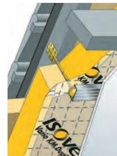
Systèmes d'étanchéité à l'air Vario sur charpente industrielle et sur charpente traditionnelle.
