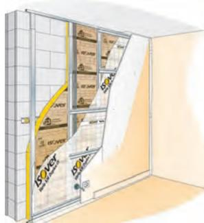
Systèmes d'étanchéité à l'air Vario sur mur maçonné
